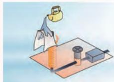
凍結した水道管にタオルなどを巻き、ゆっくりぬるま湯をかけてください。水道管が破裂する恐れがあるので、熱湯は絶対にかけないでください。
