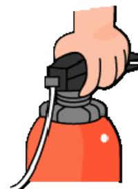
消火の要領としては、煙に惑わされず、火元を掃くようにノズルを左右に振りながら、手前の火から完全に消して前に進みます。屋外では風の影響を考えて風上から放射します。室内では自分自身の避難路を確保し、身体を低くし煙や熱気を避け火元に近付いて放射します。粉末消火器を使用した時は、燃焼物の中心まで完全に消えていないことがありますので、再燃させないためにも、水を十分かけておくことが必要です。
