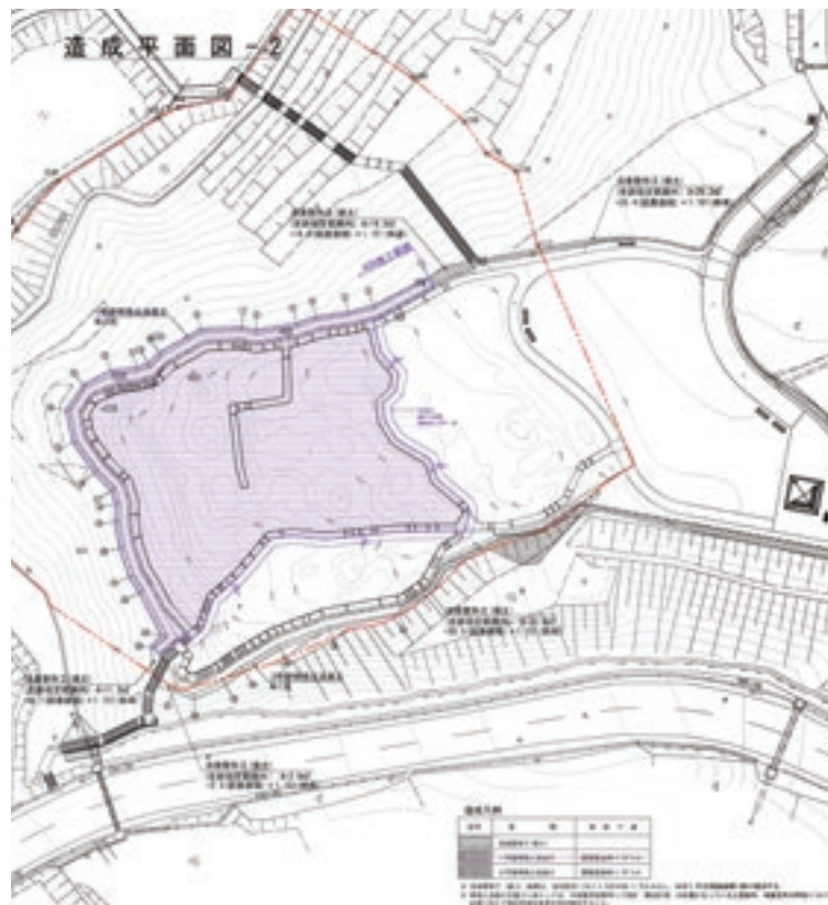
図 4.1.6 補強土法面工施工箇所
