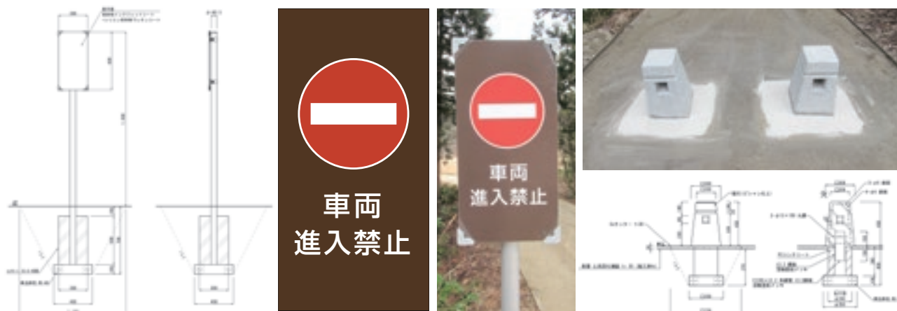
図 4.2.4 車両進入禁止サイン・車止め構造図
